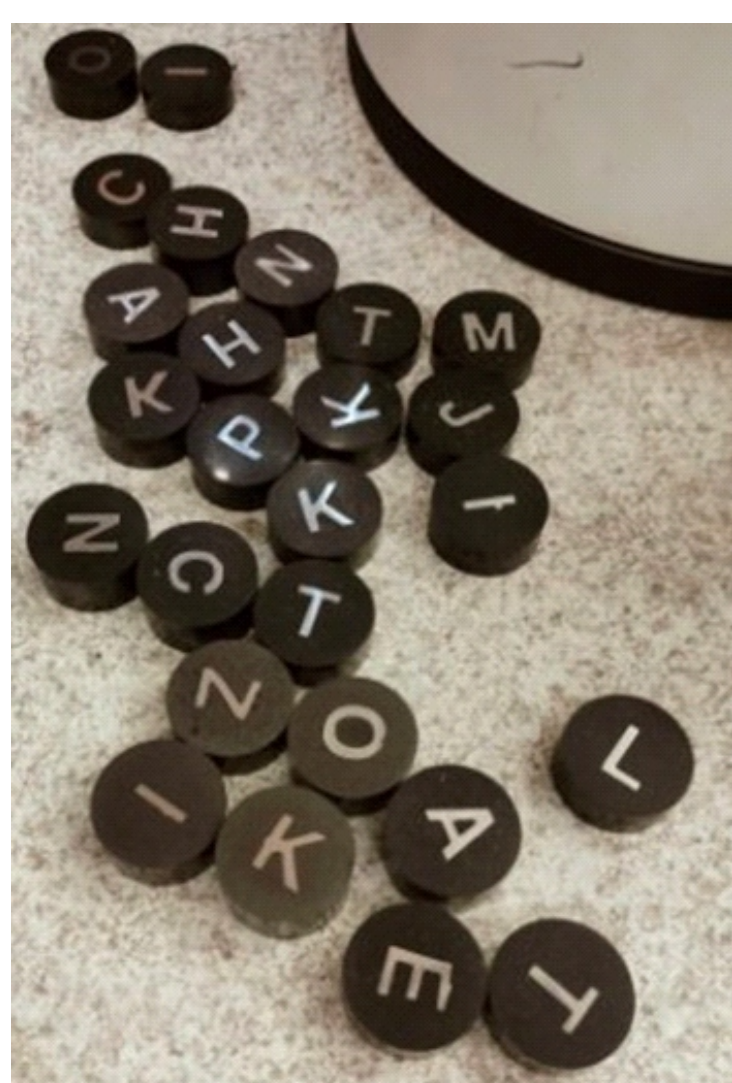
Próbki metalograficzne przygotowane do polerowania i szlifowania
