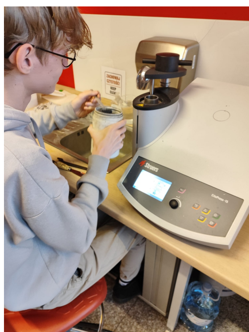
Pozyskanie złomowych próbek metalograficznych oraz przygotowanie własnych próbek w celu poznania metodyki preparatyki
